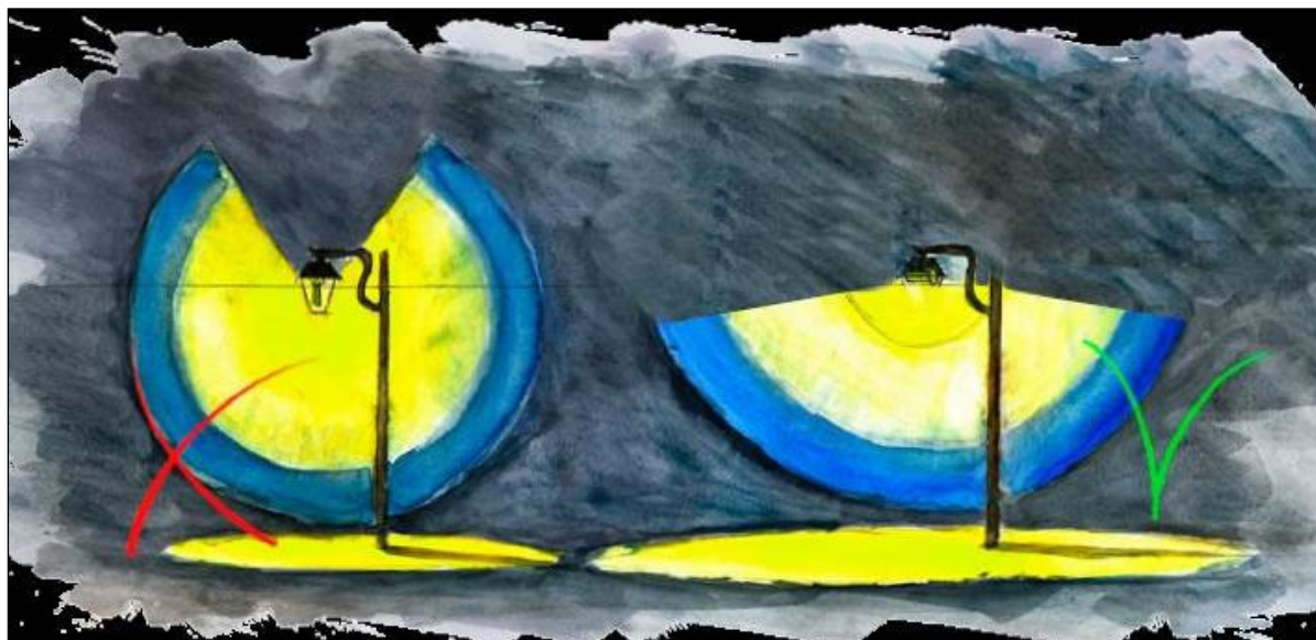
Exemples de cônes d'ombre selon la lampe (source : PNR Préalpes d'Azur)
